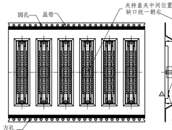
NO2: 将产品放入载带凹槽后, 用盖带封装 (冷封)
