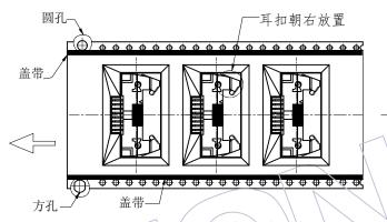
NO2:将产品放入载带凹槽后,用盖带封装(冷封)
