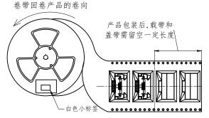
NO3: 载带卷装须依照逆时针方向卷装(如图所示) 载带尾端及盖带留空长度见《卷带包装检验规范》 (250PCS/卷)并贴上标签
